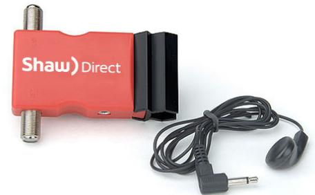
**Étape 1 :** Branchez une courte section de câble coaxial du LNB du chercheur de satellite au LNB xKu. Raccordez la borne du récepteur terminal du chercheur à un câble coaxial, puis au port SAT IN du récepteur de signaux de satellite de Shaw Direct.
